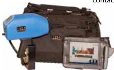
depuis l'UV vers l'IR, des éléments légers vers les plus lourds. Au départ qualitatif, cet outil peut passer au quantitatif après calibrage. Il dispose d'une journée d'autonomie. Il s'agit du même système que Chem-Cam installé sur le rover martien Curiosity.
