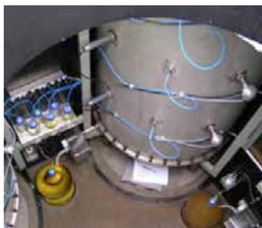
Figure 3. Station expérimentale pour l'étude des processus de pollution et dépollution des sols de sites industriels et urbains et le développement des services écosystémiques (GISFI, France)
