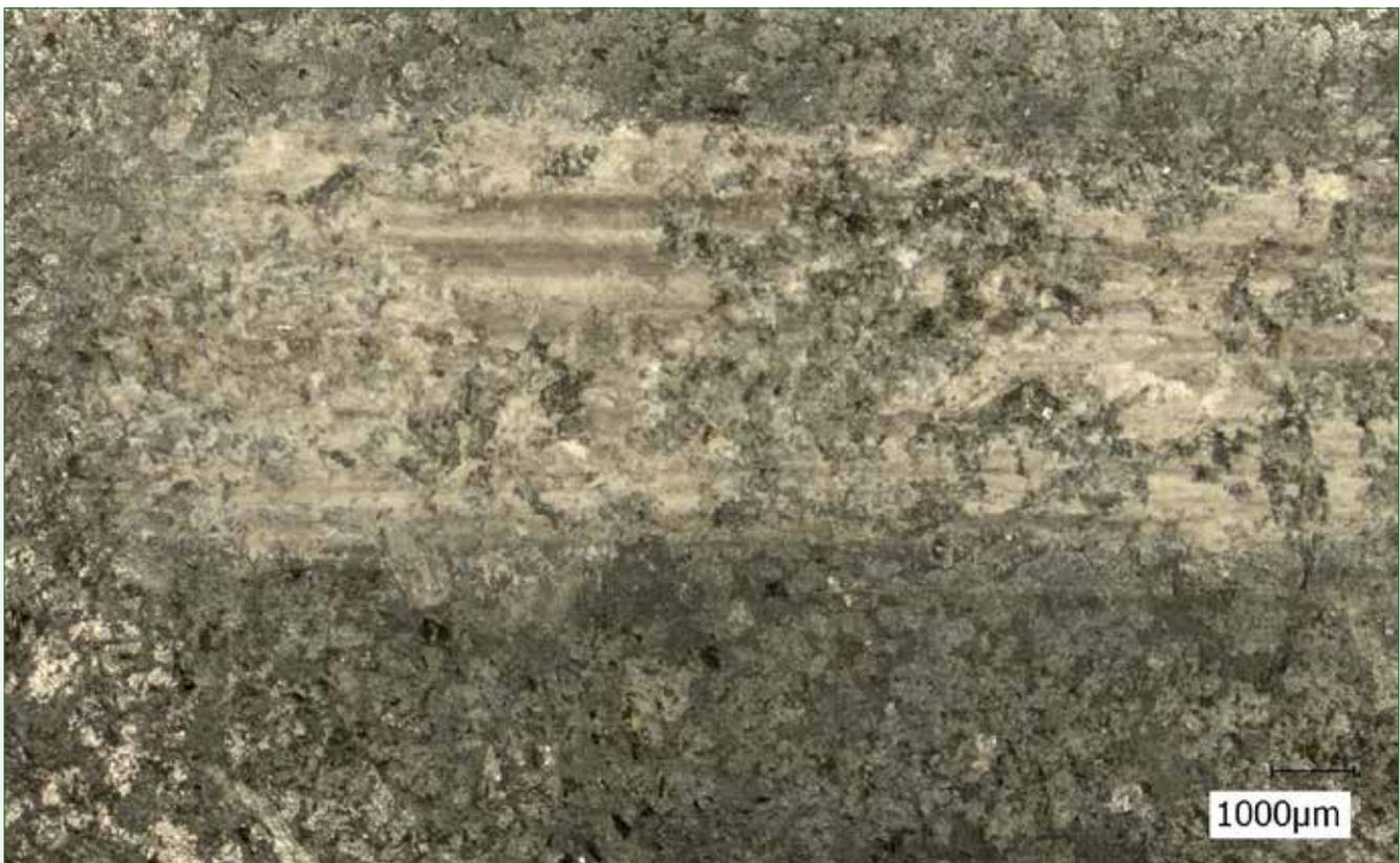
Figure 2 : Stries observées en microscopie optique sur une éprouvette de gabbro suite à un test de frottement réalisé en conditions de vitesse de glissement imposée à 500 mm/m, (env. 8 mm/s) sous une contrainte de 80 Mpa. Les stries de glissement apparaissent blanchâtres à cause de la présence de poudres de roches (gouge de faille). Le cylindre de gabbro qui a généré ces stries s'est déplacé de la droite vers la gauche de la photo.
