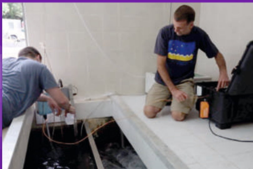
Installation du dispositif de prélèvement automatique sur la source hydrothermale de Rocca Campana (Etna, Sicilia) par l'équipe du CRPG et de l'INGV (Palermo).
