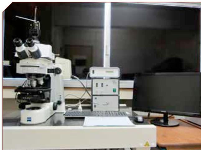
Ensemble pour l'acquisition spectrale de la fluorescence et du pouvoir réflecteur
