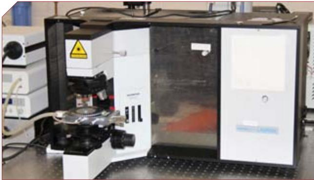
Spectromètre Raman équipé d'une platine microthermométrique
