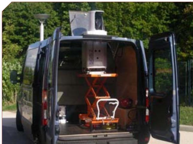
Station mobile de télédétection des gaz atmosphériques par émission infrarouge (BRUKER-SIGIS2)
