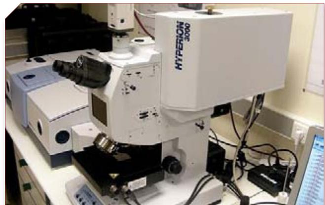
Spectromètre infrarouge couplé à la micro-imagerie (BRUKER)
