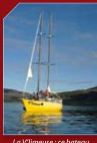
La V'limeuse : ce bateau en acier de 14 mètres est un Damien II dont la quille relevable permet d'approcher les côtes jusqu'à moins de deux mètres de tirant d'eau.
