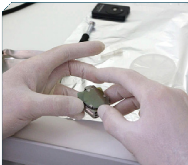
Cible concentrée en vent solaire de la mission NASA GENESIS dans le porte-échantillon avant son introduction dans la nouvelle sonde ionique IMS 1280 HRZ.
