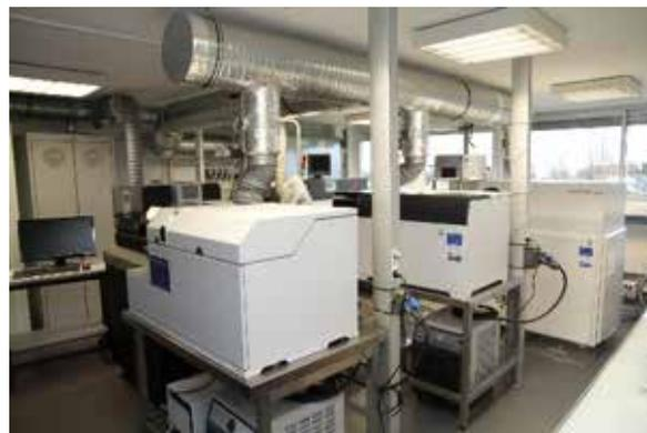
*Vue d'ensemble du laboratoire avec au premier plan de gauche à droite, i) ICP-MS quadrupolaire Agilent 7500, ii) ICP-MS triple quadrupole Agilent 8900, iii) ICP-MS haute résolution à secteur magnétique Attom-Nu Instruments. Au second plan, lasers excimer 193 nm NWR et GeoLas*
